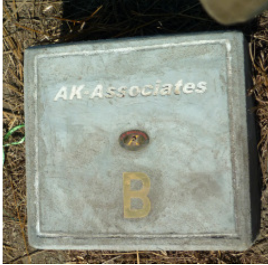
စက်ရုံဆောက်လုပ်ရန် လေ့လာဆန်းစစ်မှုများ ပြုလုပ်ခဲ့သည့် AK-Associates ကုမ္ပဏီတံဆိပ်ပါ မြေနေရာအမှတ်အသားတစ်ခု
